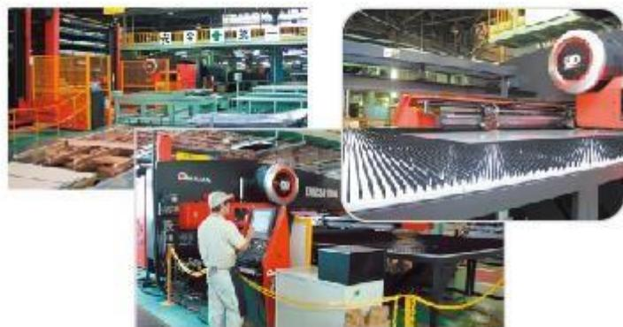
Step1：在冲切工序时，运用 AMADA 的数控冲床和自动堆垛设备后，只要将指令导入设备系统中，就可以实现自动化无人操作，大大提高了加工效率。在实际加工阶段 AMADA 的自动化设备保证了产品的加工精度，同时还提高了加工效率。
