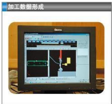
Step2:AP100 软件根据 CAD/CAM 模型，形成加工数据。
