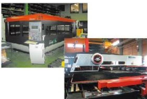
Step2: 操作人员只要将加工数据录入到设备装置内，设备会自动根据数据进行实际加工
