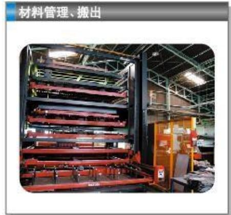
Step1: 用叉车托盘交换装置 ASF-3015FO，自动准备加工材料。
